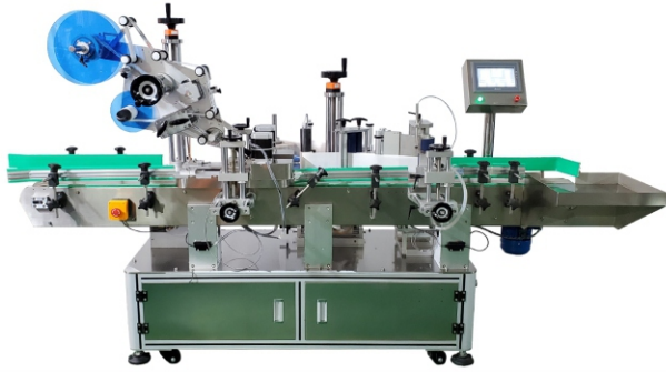
| 全自动平面圆瓶一体贴标机 |
